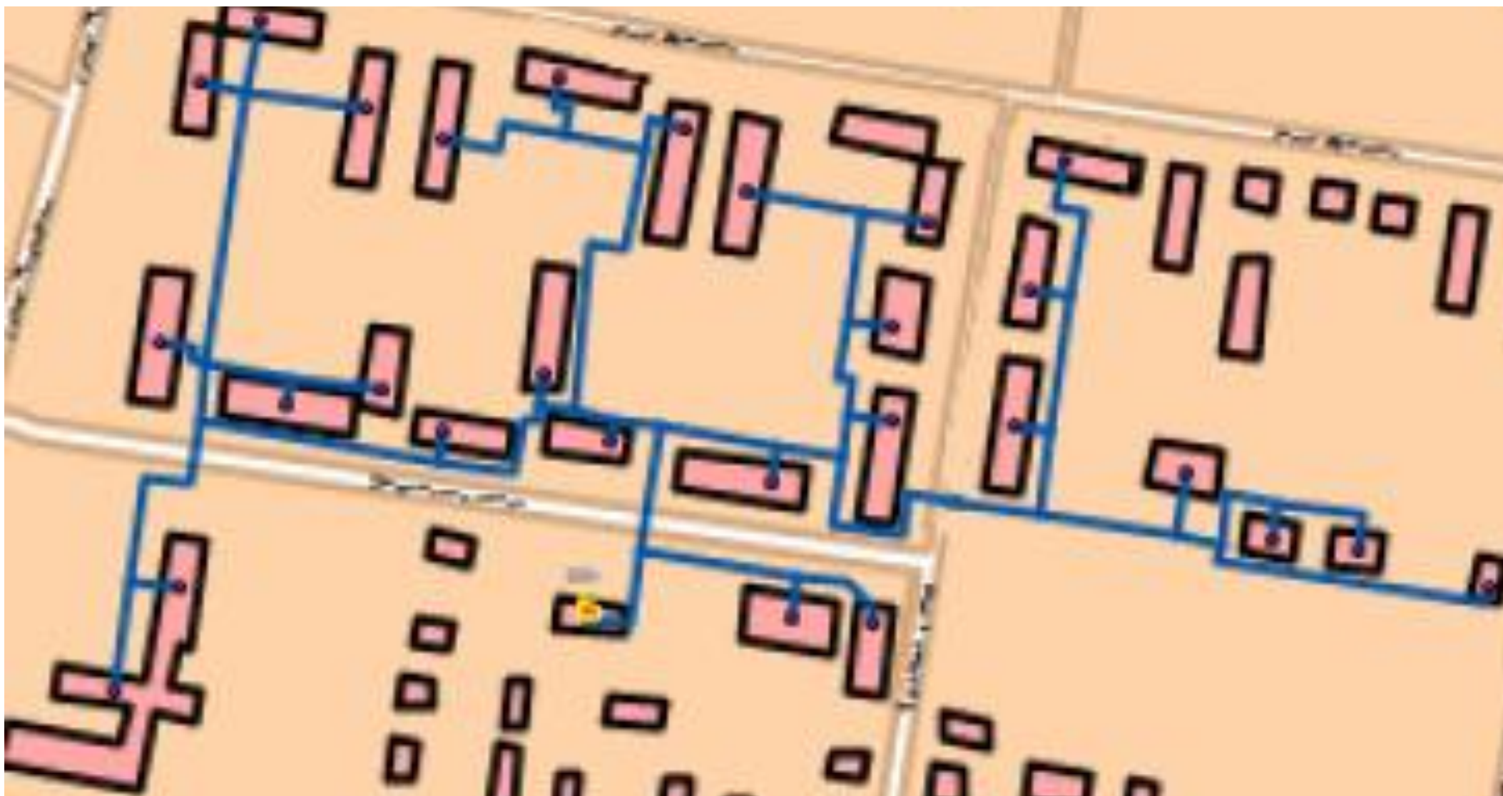
Рис.№11- Тепловые сети от Модульной котельной №1
