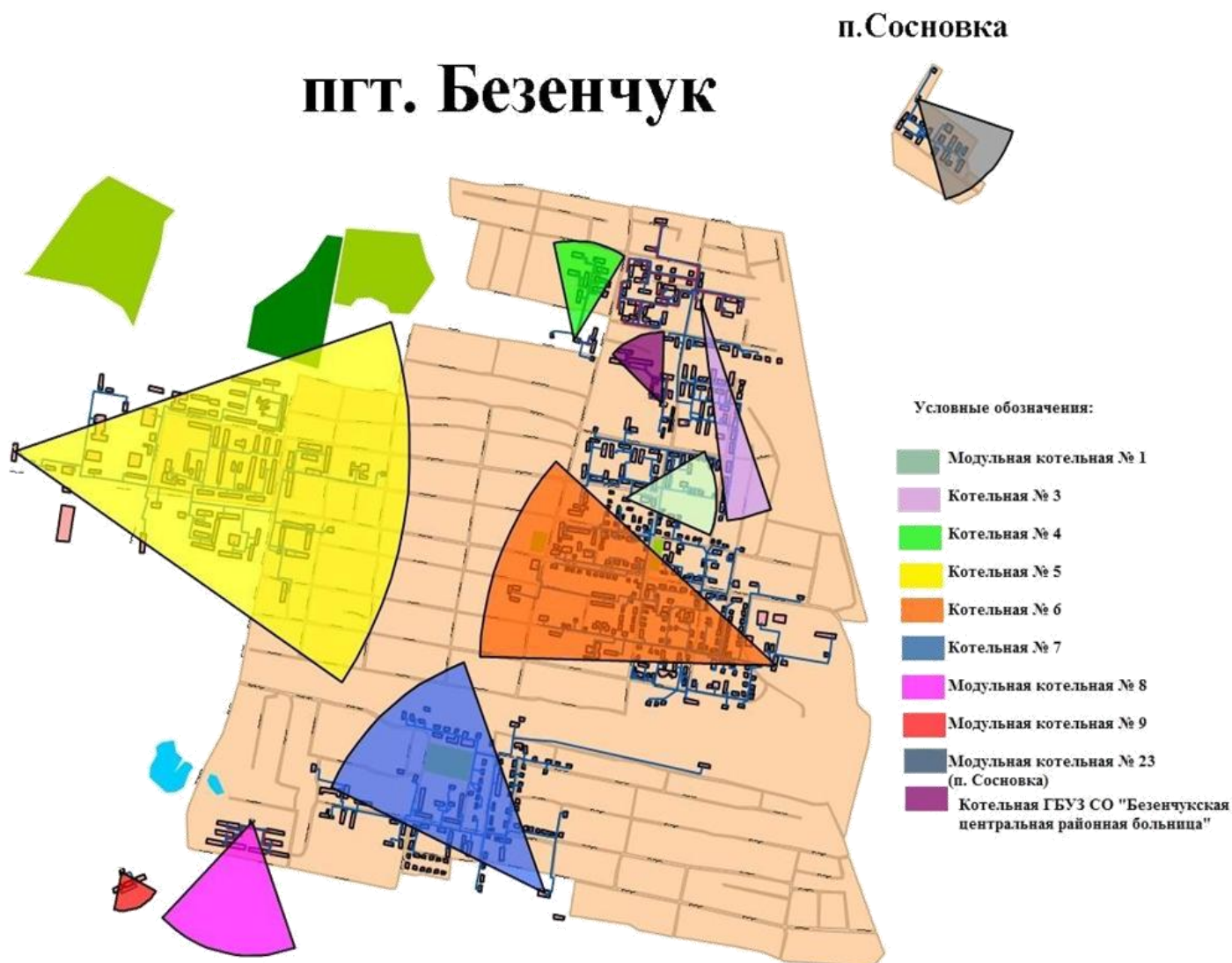
Рис. №4 - Радиусы эффективного теплоснабжения
