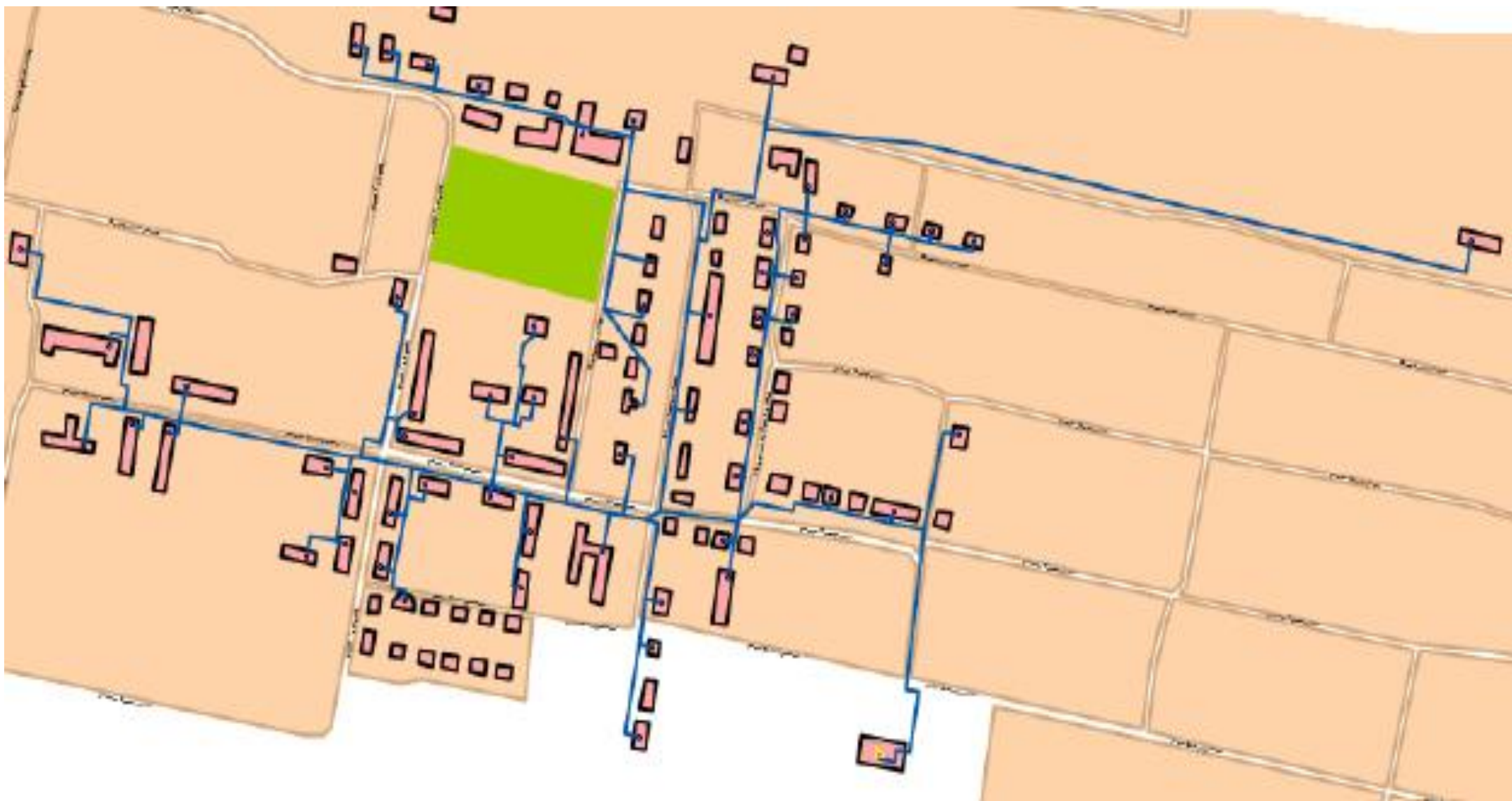
Рис.№ 17 - Тепловые сети от котельной № 7
