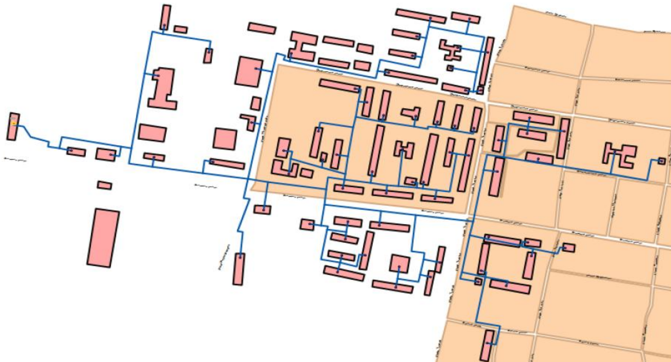
Рис. № 15- Тепловые сети от котельной №5
